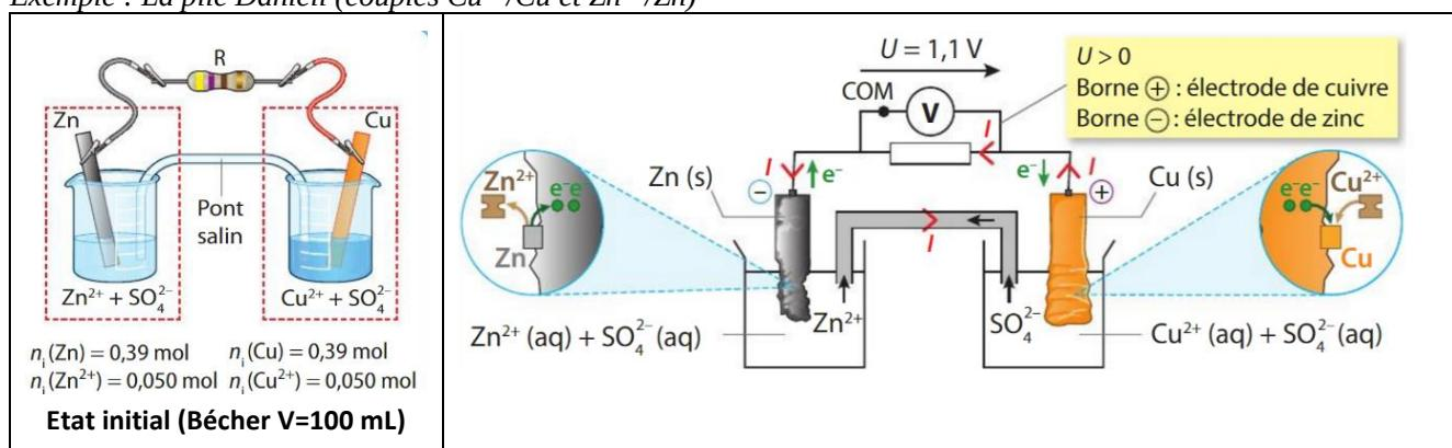
Dans cette pile, une électrode de Zinc plongée dans une solution de sulfate de zinc, est reliée à une électrode de cuivre plongée dans une solution de sulfate de cuivre.
